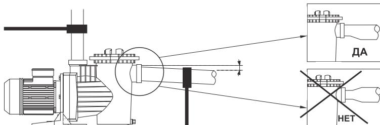
É muito importante que as tubagens de aspiração e impulsão possuam suportes independentes e que fiquem bem fixas, para que, desta maneira, a bomba não suporte o seu peso nem as vibrações produzidas pela passagem do caudal de água através das mesmas. No caso de instalar uma tubagem de impulsão de grande comprimento, aconselhamos a instalação de uma válvula de retenção para evitar que o golpe de aríete produzido pelo retorno da água ao parar a bomba provoque algum estrago.
