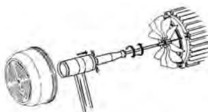
Zkontrolujte, zda směr otáčení motoru souhlasí s údajem uvedeným na výkonovém štítku (vrtulka ventilátoru se musí při pohledu ze zadu točit VE SMĚRU HODINOVÝCH RUČIČEK). Jestliže se jedná o trifázový motor a zjistíme, že se točí opačným směrem, je nutno mezi sebou vyměnit na jističi dva fázové přívodní vodiče.
