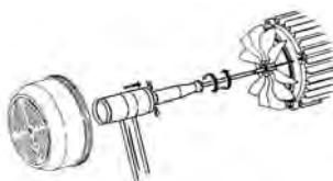
Vérifier que le sens du mouvement tournant du moteur coïncide avec celui qui est indiqué sur la plaque des caractéristiques (le ventilateur doit tourner , en regardant par le côté arrière du moteur, dans LE SENS DES AIGUILLES D'UNE MONTRE). Si la pompe est triphasique et que nous observons que le sens du mouvement est incorrect, il faudra inverser deux phases d'alimentation du tableau de protection.
