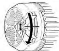
Prüfen, ob die Drehrichtung des Motors mit der Angabe auf dem Typenschild übereinstimmt (der Lüfter des Motors muß sich von hinten gesehen im UHRZEIGERSINN drehen). Bei einer Pumpe mit Dreiphasenmotor müssen bei falscher Drehrichtung zwei Phasen der Netzzuleitung am Schutzgerät vertauscht werden.
