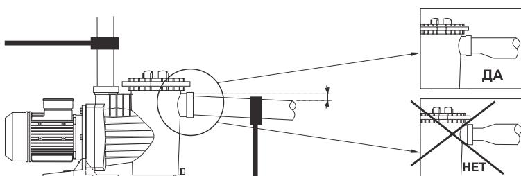
Emis ve basma hatlarının pompa bağlantısının dışında desteklenmesi çok önemlidir. Tesisatın su akışından kaynaklanan titreşimlerin pompa bağlantısı ile desteklenmesi mümkün değildir. Uzun mesafeli basma hatlarında pompaların ani durdurulmasından kaynaklanan su çekicini önlemek için basma hattına çekvalf bağlanması önerilir.
