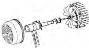
Verifique se o sentido de rotação do motor coincide com o indicado na placa de características (a ventoinha deve rodar, olhando pela parte traseira do motor, no SENTIDO DIRECTO). Se a bomba for trifásica e observarmos que o sentido de rotação é incorrecto, devem-se inverter duas fases de alimentação do quadro de protecção.
