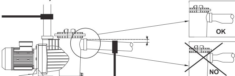
Je velmi důležité, aby sací i výtláčné potrubí byla nezávisle podepřena a správně upevněna tak, aby čerpadlo nemuselo nést jejich váhu a netrpělo vibracemi vznikajícími při prouďení vody v těchto potrubích. Pokud se použije dlouhé výtláčné potrubí, doporučujeme nainstalovat zpětný ventil, aby se předešlo rázu vody při jejím zpětném prouďení po zastavení čerpadla, což by mohlo zařízení poškodit.
