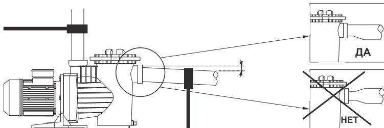
Как всасывающую, так и напорную трубу необходимо тщательно закрепить на отдельных опорах во избежание воздействия нагрузок или вибраций, производимых проходом водяного потока через трубы. В случае установки напорной трубы большой длины рекомендуется установить запорный клапан, который снижает риск гидравлического удара, вызванного обратным током воды в результате остановки насоса.
